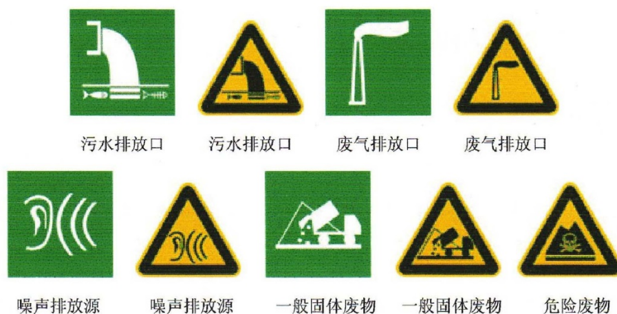
图 13.3-1 排放口图形标志图（背景绿色表示提示图形，背景黄色表示警告图形）
